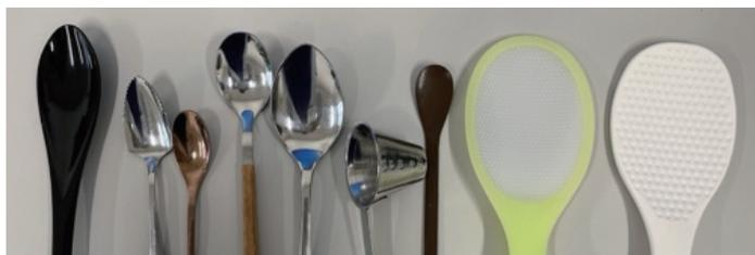
その見た目でもろみの付き具合を判断される。今回我々はスプーンのように手軽に使えるとろみ粘度測定機器の開発を行った。様々な形状のものを試作し、手軽に使い適切にとろみ粘度を評価できる機器の形状を決定した。現在試作品を作成中であり、実際に臨床で活用することができれば今まで主観的に判断していたとろみの付き具合を簡便に確認し、明確な基準とすることができる。
