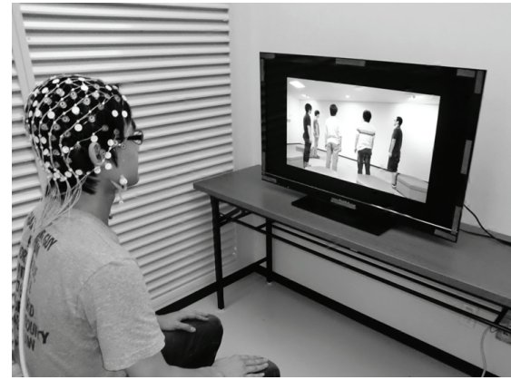
図2. 実験2の実験風景（脳波を測定しながら他者が起立-着席運動を行っている映像を観察している様子）
